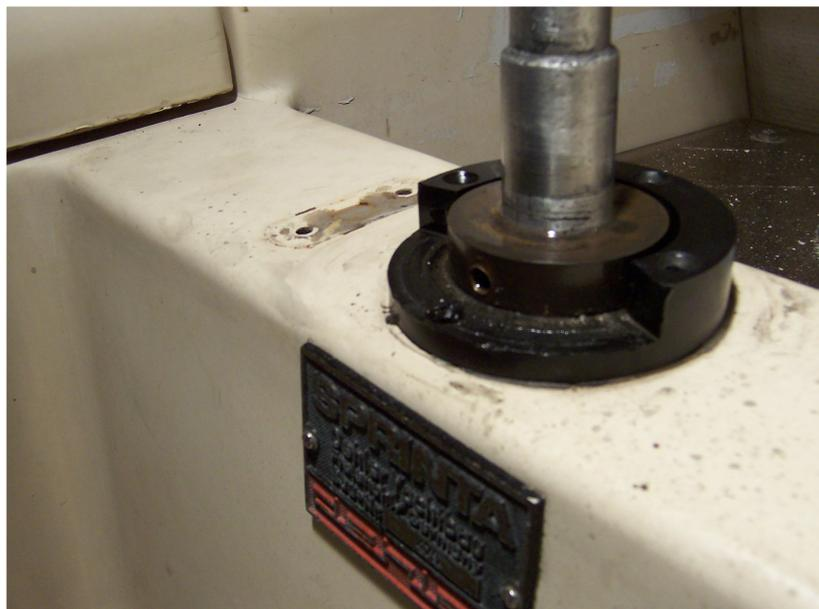
**Man sieht hier gut das Loch in dem die Madenschraube, oder wie bei mir die Schraube mit Kontermutter saß.**
